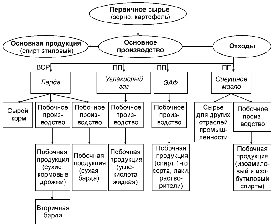
Рис. 67. Схема образования ВСП и отходов при производстве спирта из зернокартофельного сырья
