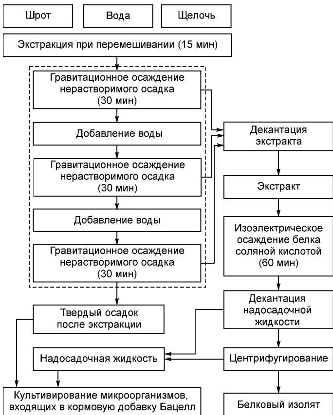
Рис. 57. Технологическая схема безотходной переработки подсолнечного шрота
