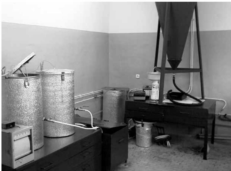
Рис. 62. Опытно-промышленная установка для получения биодизельного топлива ОПУ-1-БД
