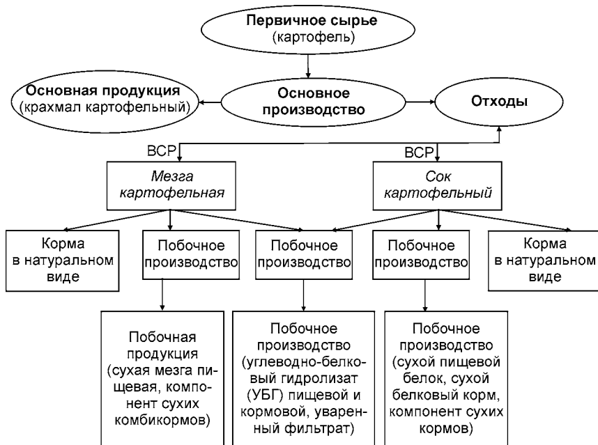
Рис. 71. Схема образования ВСР и отходов в крахмалопаточной промышленности (картофелекрахмальное производство)
