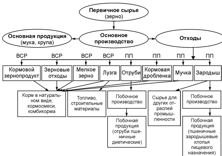
Рис. 43. Поток образования и использования ВСР и отходов зерноперерабатывающей промышленности:
