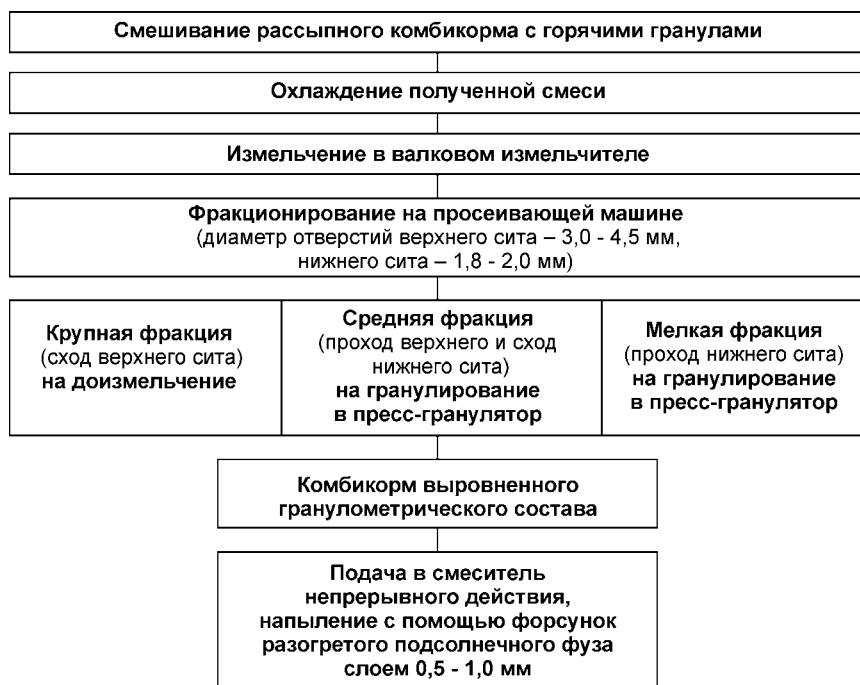
Рис. 59. Получение гранулометрического комбикорма с добавлением подсолнечного фуза
